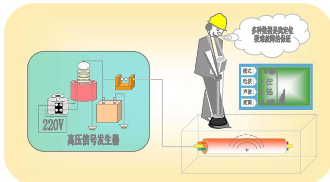
一体化高压脉冲发生器采用了世界上最先进的工艺和技术，在功能、性能和应用范围上都远远超过了其它同类产品。便于携带和现场使用，与 DDY-3000 电缆故障定位仪、KC-900 三级脉冲电缆故障测试仪等配套使用能够对各种电缆故障进行精确定点。
